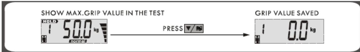
Presiones el botón Después de guardar, el dinamómetro volverá de nuevo a modo de prueba.
