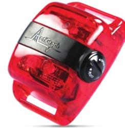
Es un monitor de actividad sofisticado, fue rediseñado y combina el acelerómetro de 3 ejes validado y la tecnología de filtrado de datos con un perfil bajo y una variedad de nuevas funciones avanzadas, que incluyen:
